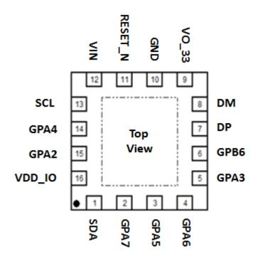
Figure 7-1 PL23C3 Pin Diagram (QFN16)
