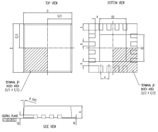
Figure 12-1 PL23C3 Outline Diagram (QFN16)
